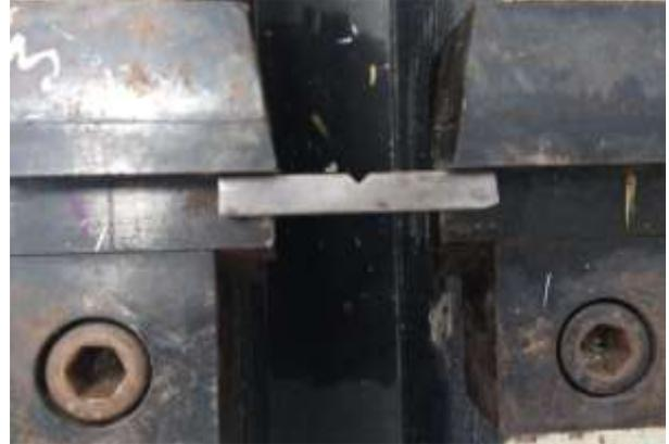
Figura 1. Montaje general de la probeta en la máquina de impacto.
