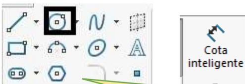
27. Para hacer el siguiente corte, debe dirigirse al plano planta para poder ubicarse en la parte de abajo de la figura, debe tener conocimiento de la siguiente herramienta: CIRCULO, luego de poner esta herramienta se debe acotar la figura para que quede completamente definido con se muestra en la figura.
