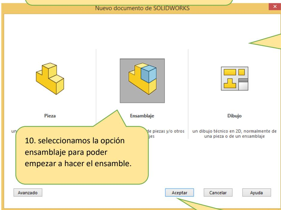
9. Luego de seleccionarlo, se despliega tres opciones: PIEZA, ENZAMBLAJE Y DIBUJO.
