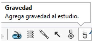
17. Se agregará seleccionado la herramienta **GRAVEDAD** luego de esto aparece un cuadro el cual muestra la opción donde el eje de la pieza le da gravedad y **ACEPTAR**.
