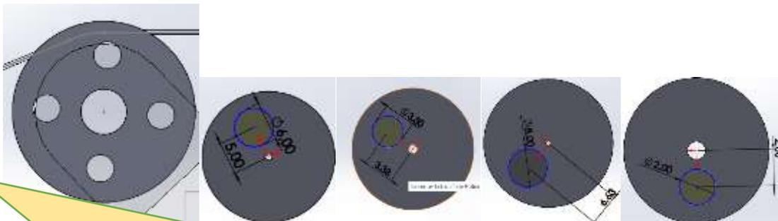
16. Para hacer los orificios seleccionar croquis sobre la polea, realizar con un círculo seguido de la opción extruir corte, luego para distribuirlos sobre la superficie, seleccionar la opción matriz y definir posición y cantidad de huecos para cada polea.
