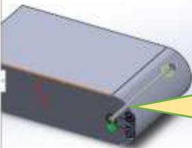
39. Para hacer el siguiente corte, se debe dirigir al plano planta para poder ubicarse en la parte lateral de la figura, se debe tener conocimiento de la siguiente herramienta: RECTANGULAR, luego de poner esta herramienta se debe acotar la figura para que quede completamente definido con se muestra en la figura.
