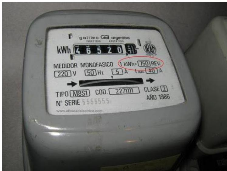
FIGURA 3.1 CONSTANTE DE UN CONTADOR
