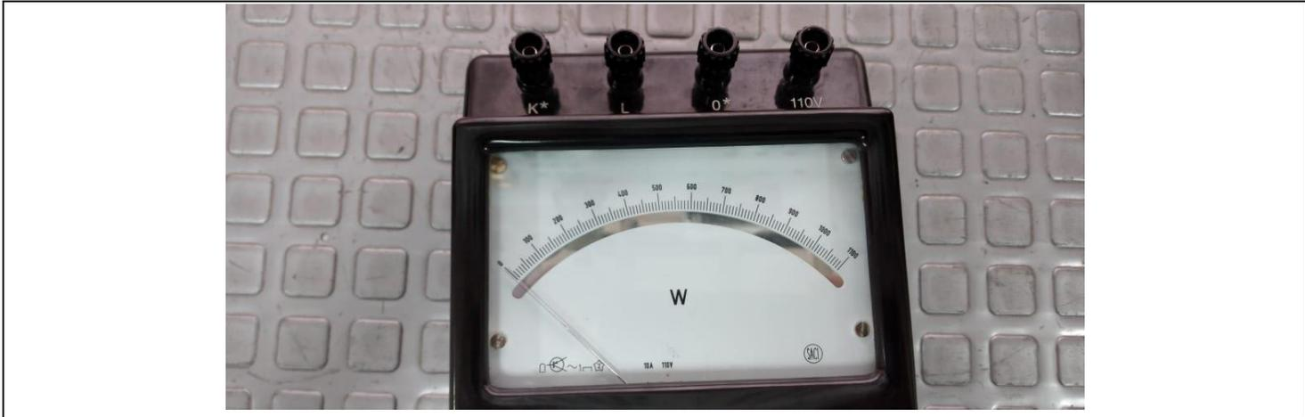
Vatímetro electrodinámico SACI . LAB. MEDIDAS ELECTRICAS UTS
