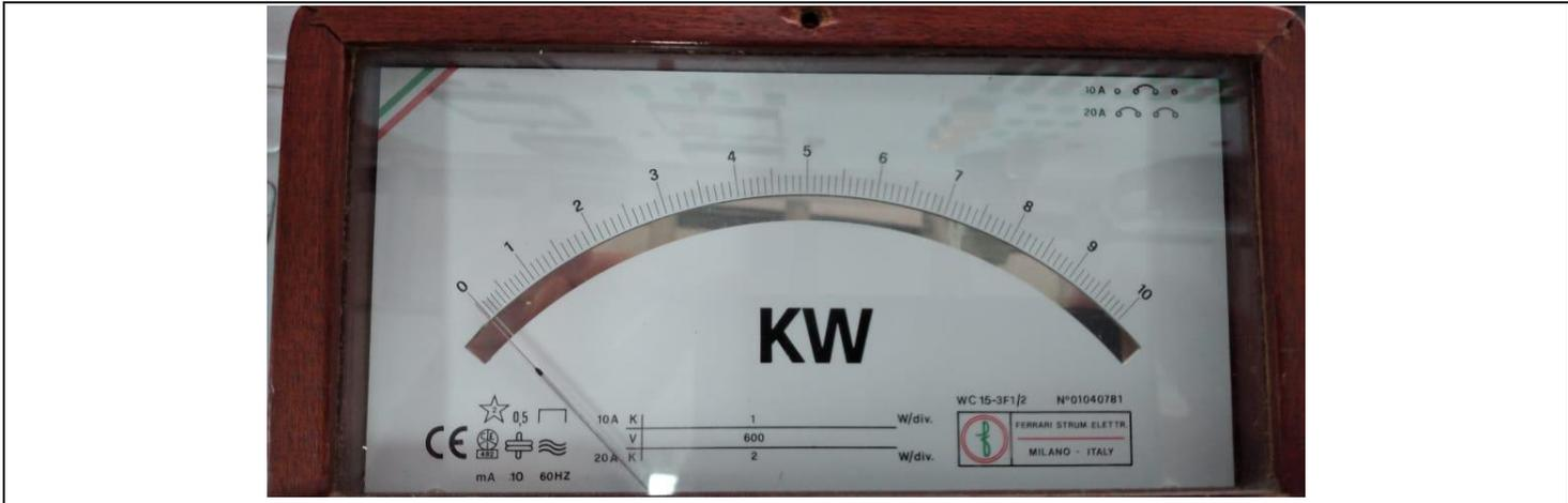
Vatímetro electrodinámico FERRARI. LAB. MEDIDAS ELECTRICAS UTS
