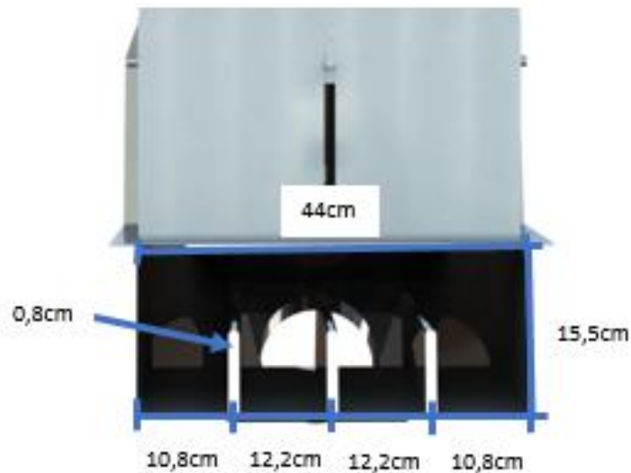
Figura 41. Medidas en vista posterior de la CPF de ACIV.
