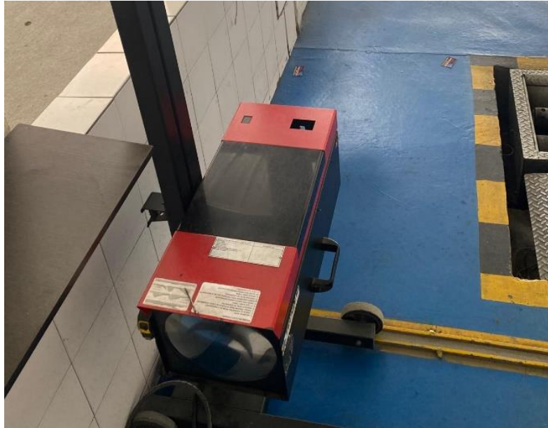
Figura 28 . Alineador de luces (intensidad e inclinación ) (batería 12 V)
