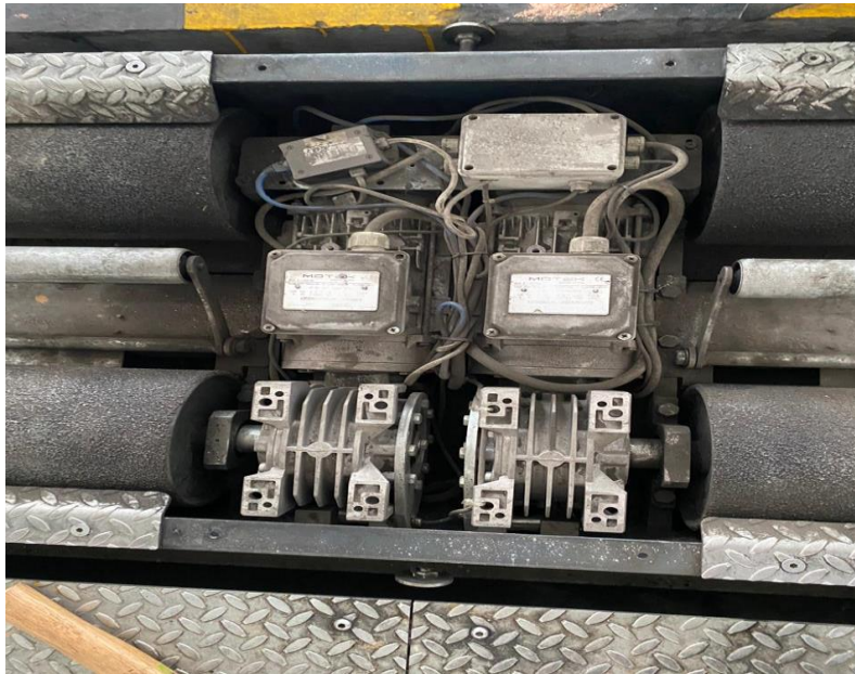
Figura 27 . Frenómetro para realización pruebas de frenos a vehículos livianos (5 kW/por motor)
