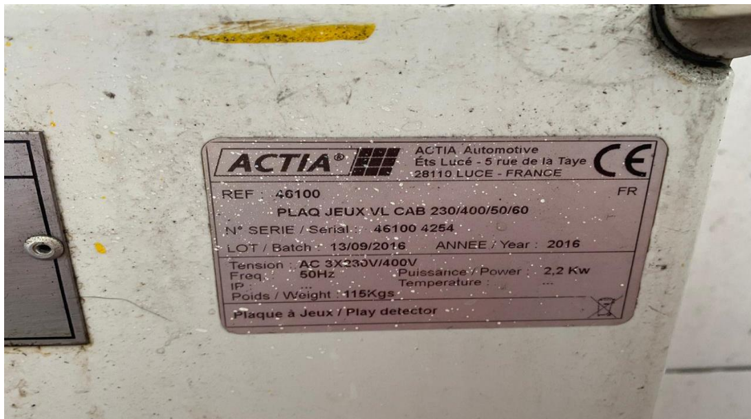
Figura 29 . Placas electrohidráulicas (2.2 kw)
