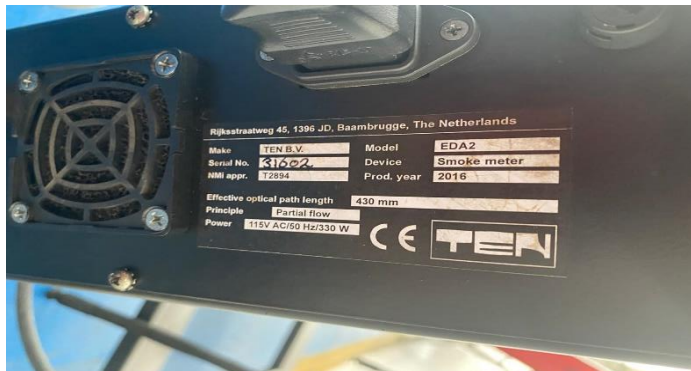
Figura 23 . Equipo para realizar pruebas a vehículos Opacímetro (115V AC/50 HZ 330 W combustible diesels)
