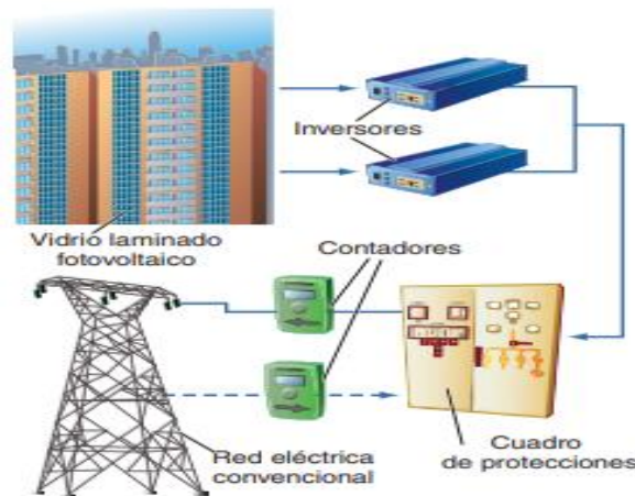
Figura. 7 Sistema fotovoltaico conectado a la red
