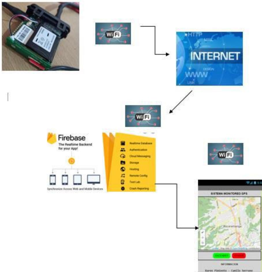
El diagrama está compuesto por un dispositivo electrónico llamado Suntech, que es un geo localizador, para instalar a vehículos, en este caso a una motocicleta; este dispositivo se configura conectado a una dirección Ip pública fija, del servidor que proporciona el operador de internet, en este caso la dirección Ip pública fija es: 190.147.210.115, con un puerto que también habilita el operador de internet, el puerto que tenemos en uso es: 9191.
