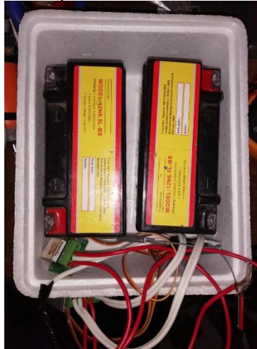
Figura 35.impermabilización del hardware
