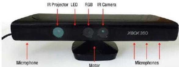
Fig.4 Componentes de Kinect 1.0
