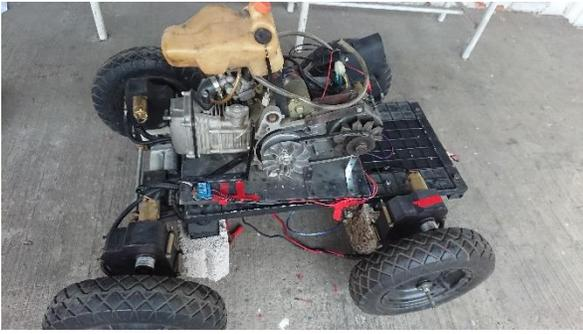
Fig. 9. Plataforma robótica móvil a la cual se le acoplo el motor de combustión interna.
