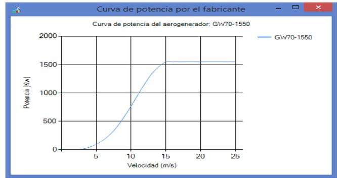
Fig. 12 Curva de potencia (GW70-1550) diseñada por el fabricante
