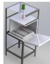
Figura 1. Diseño del horno de compresión modelado en 3D Fuente: Autores, mediante Software Solidworks<sup>®</sup> 2017
