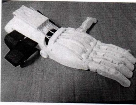
Fig. 3 Prótesis impresa en 3D
