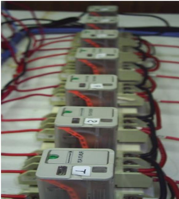
Figura 14. Relevador electromecánico empleado.
