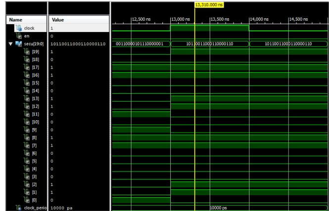
Figura 4. Simulación del generador de números pseudoaleatorios en VHDL Test Bench de Xilinx ISE.
