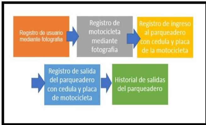
Fig. 1. Diagrama base representando el ciclo que cumplirá la información a través del sistema
