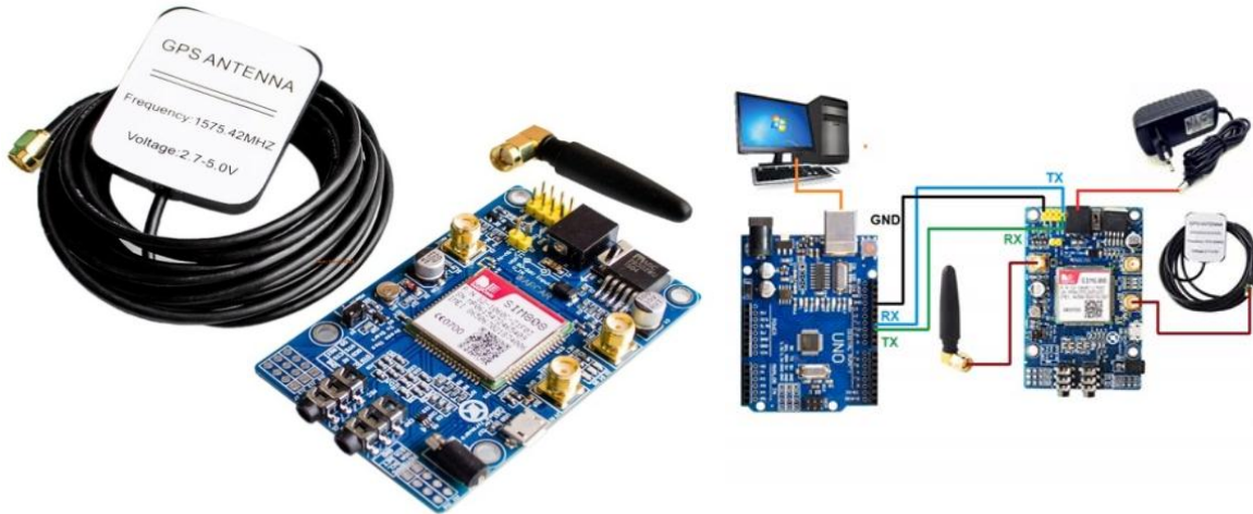
Figura 3. Módulo Sim808 Con Antena GSM Y GPS Arduino
