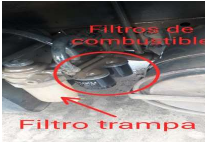
Figura 27. Foto de los filtros de combustible de una camioneta de transporte administrativo. Fuente: Captura, autoría propia (2020)
