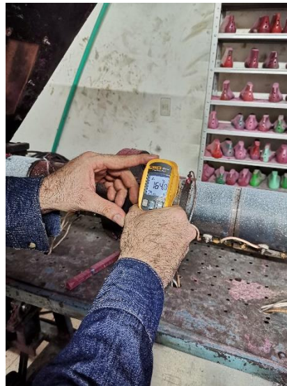
Figura 14. Verificación y calibración de temperatura
