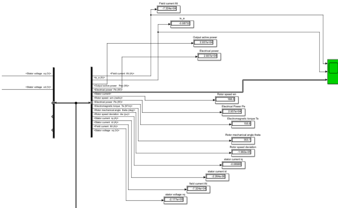
Figura 18. Bus de salida de la máquina sincrónica, display para la visualización de resultados durante la ejecución de la simulación
