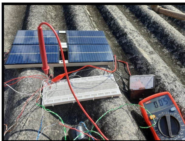
Figura 28. Medición de voltaje vs corriente
