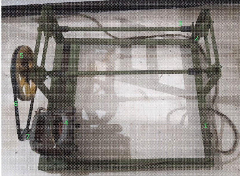
Figura 19. Ensamble del rodamiento sobre la estructura base de la máquina de polichado de rocas, vista superior.
