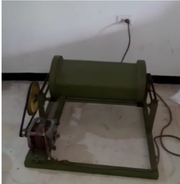
Figura 28. Instalación del tambor y conexión de la máquina a la red.
