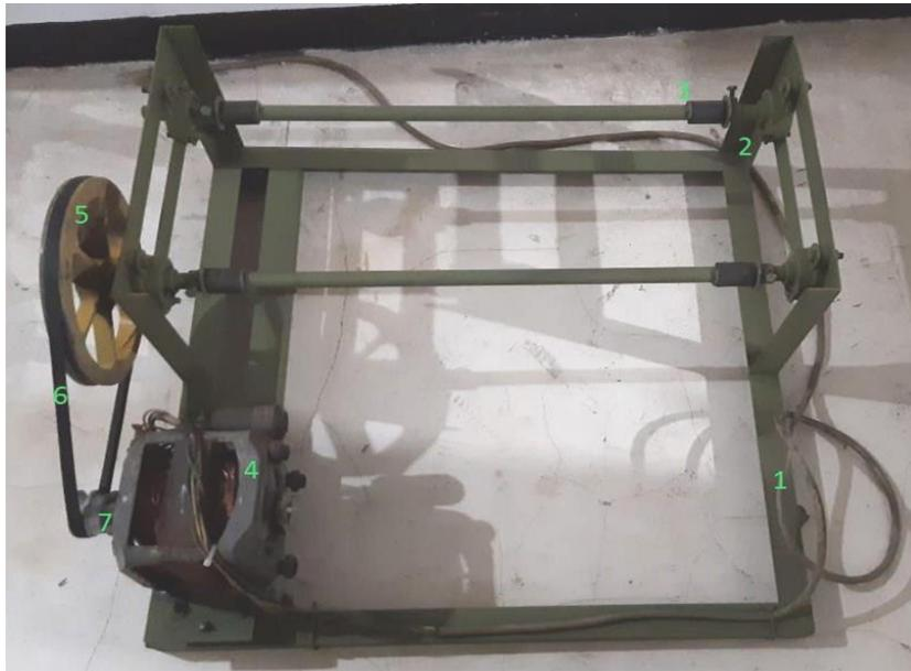
**Figura 15.** Ensamble del rodamiento sobre la estructura base de la máquina de polichado de rocas, vista superior.
