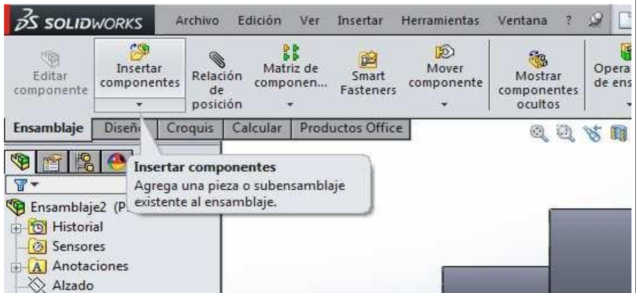
Figura 6. OPERACIÓN INSERTAR COMPONENTES
