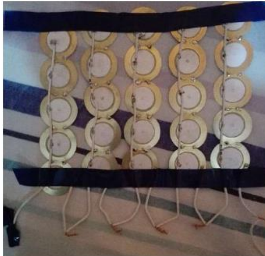
Figura 10. Conexión serie paralelo de discos piezoeléctricos
