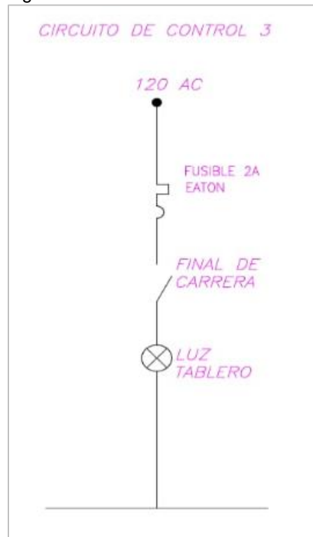
Figura 39. Circuito eléctrico del fusible
