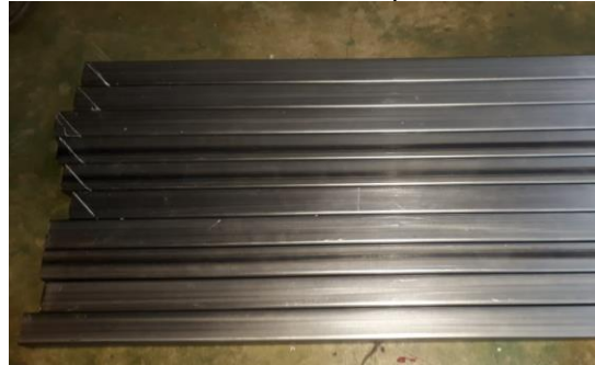
Figura 41. Corte del tubo cuadrado de acero galvanizado de 1" x 1" para la construcción del soporte
