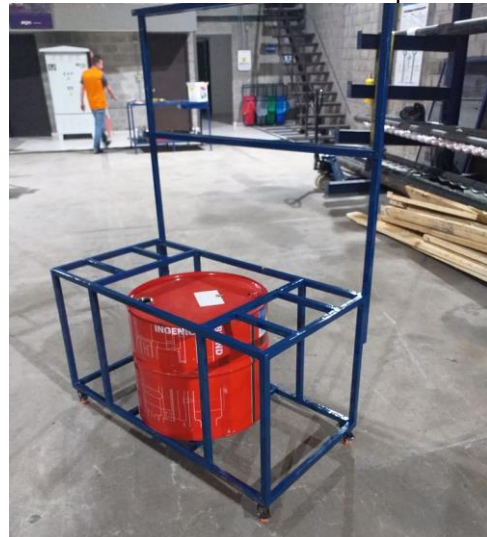
Figura 43. Ubicación del tanque de almacenamiento en el banco de pruebas
