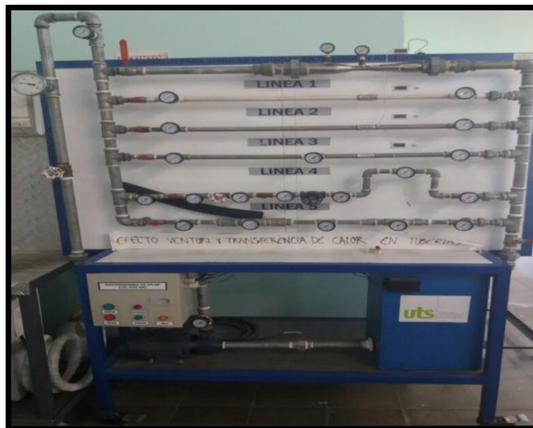
Figura 7. Banco de pruebas de mecánica fluidos Actual
