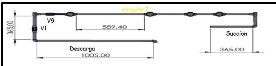
Figura 17. Circuito 7 material hierro galvanizado
