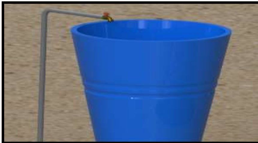
Figura 28. Tanque para mezcla de estiércol más agua
