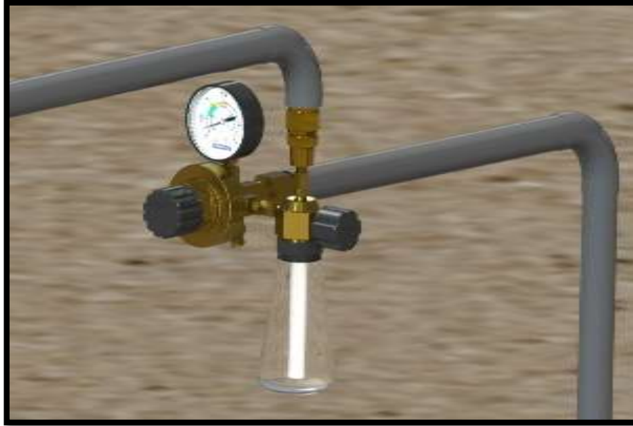
Figura 31. Válvula reguladora de Gas con trampa de agua
