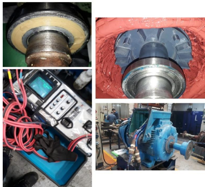
Figura 5. Cambio de rodamientos de abiertos a sellados referencia 2Z/ C3 SKF
