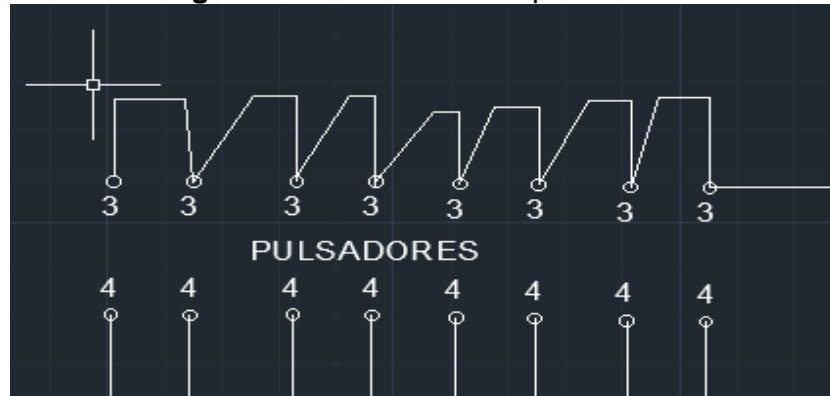
Figura 26. conexión de los pulsadores
