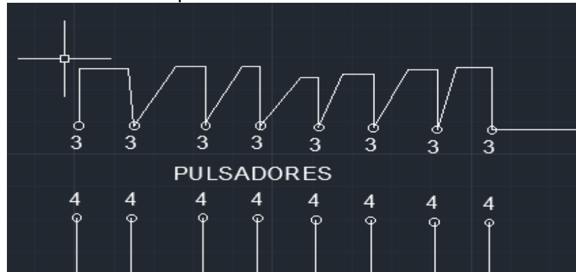
Figura 70. conexión de los pulsadores
