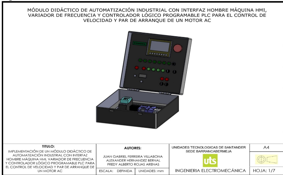
Figura 48. Modulo didáctico de automatización industrial
