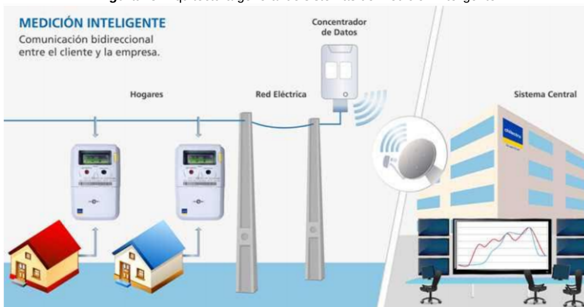
Figura 13. Arquitectura general de sistemas de medición inteligente
