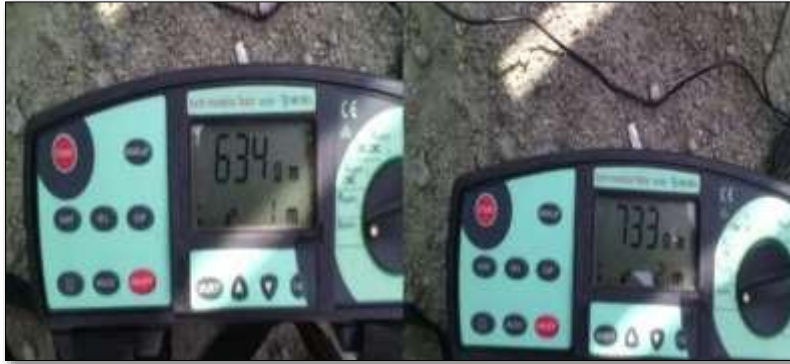
Figura 4-11. Medidas de resistividad proyecto.
