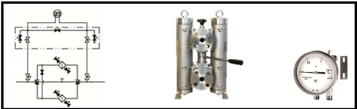
Figura 21: filtros del sistema de lubricación
