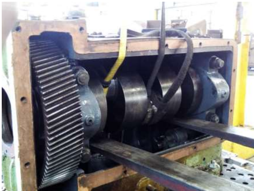
Figura 3. Desarmado de un compresor tipo pistón
