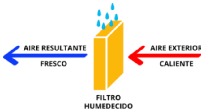
Figura 1. Enfriamiento por evaporación
