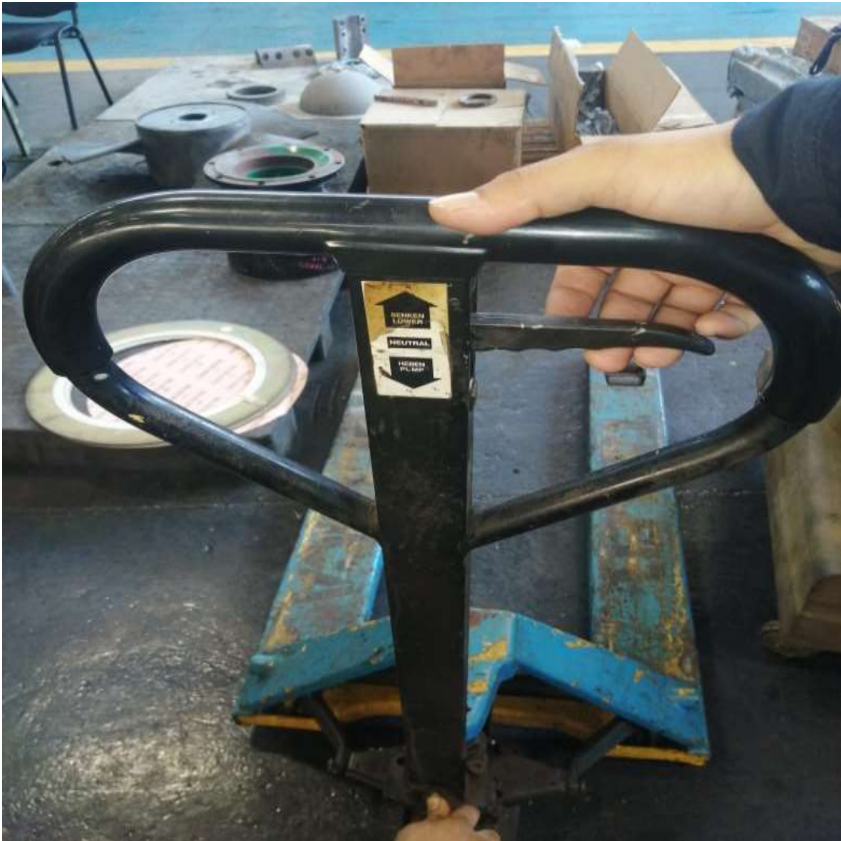
Figura 17. Lubricación de gatillo
