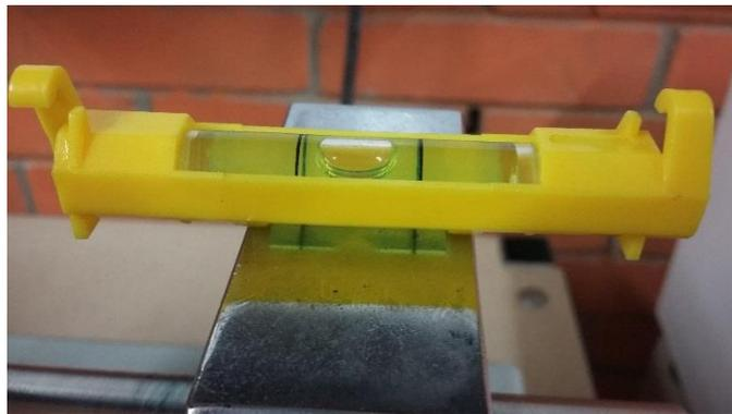
b) Nivelador montado a lo ancho del apoyo primario.
