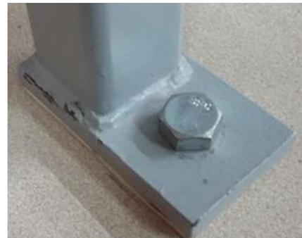
b) Apoyo bancada del motor y eje secundario respecto a la mesa.
