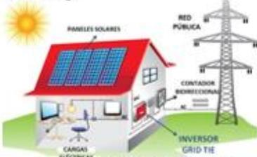
Figura 1. Esquema simplificado de un sistema Grid-Tie
