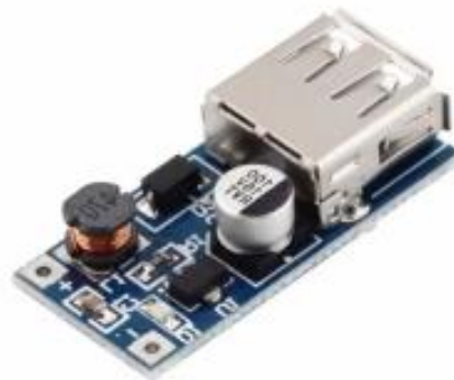
Figura 54. Modulo Elevador de Voltaje.
