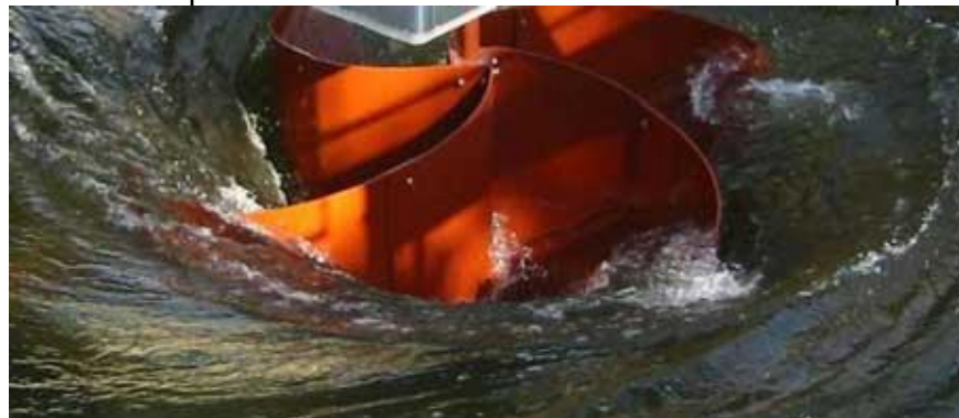
Figura 16. Vista panorámica de una turbina de cuatro alabes en operación.
