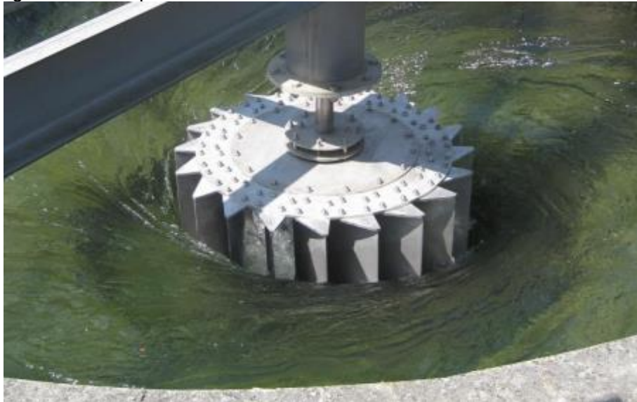
Figura 2. Vista panorámica de una turbina Zotlöterer en funcionamiento
