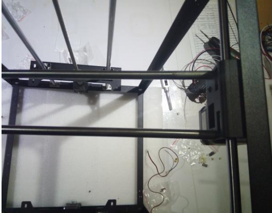
Figura 27. Carriles movimientos ejes X y Y
