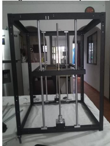
Figura 26. Doble eje Z acoplado
