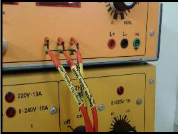
Figura 26. Conexión cables estereofónicos a las boquillas del módulo de la potencia mecánica DL 10055N.
