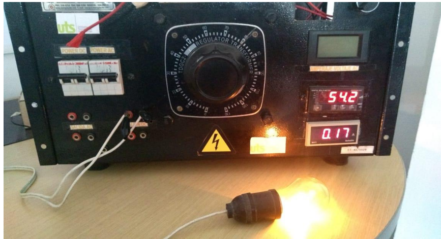
Imagen 46. corrección y pruebas de corriente y voltaje en el amperímetro Dc 49
