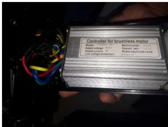
Figura 12; Cableado de controlador de motor
