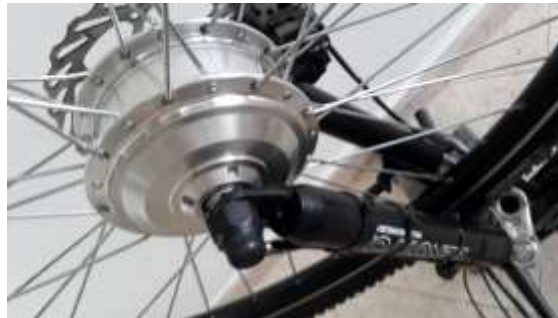
Figura 15; Motor brushless DC, adaptado a la rueda delantera
