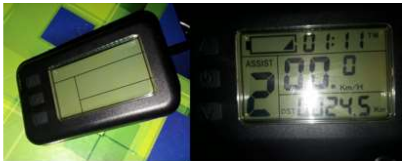
Figura 18; Pantalla LCD, pre (izquierda) y post (derecha) instalación
