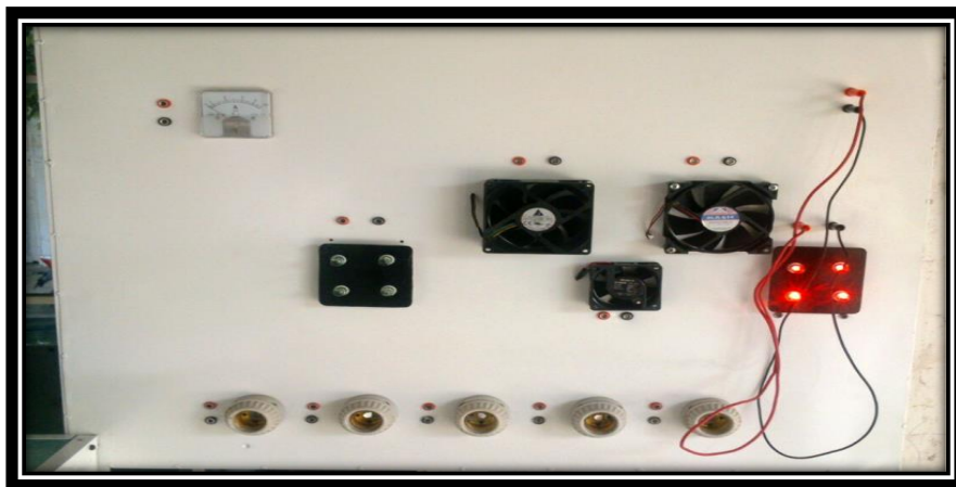
Figura 17. Prueba de encendido leds
