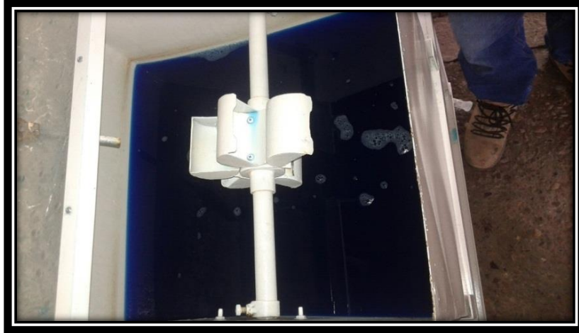
Figura 11. Alabes ensamblados dentro de la caja de almacenamiento del agua
