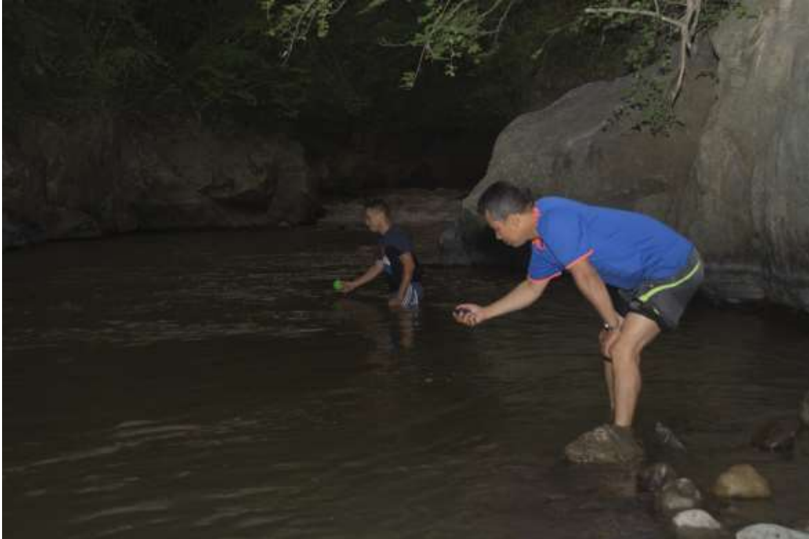
Figura 4. Método del flotador, desplazamiento de la boya y medición del tiempo
