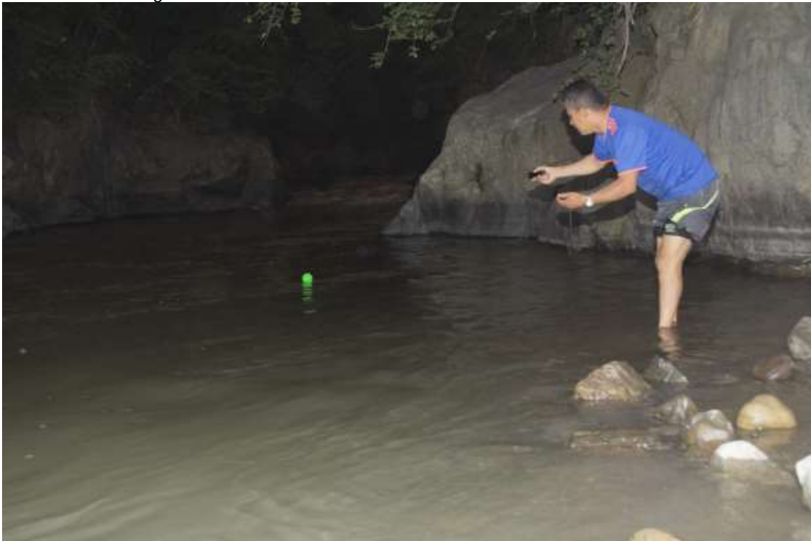
Figura 9. Determinación de la velocidad con el método del flotador
