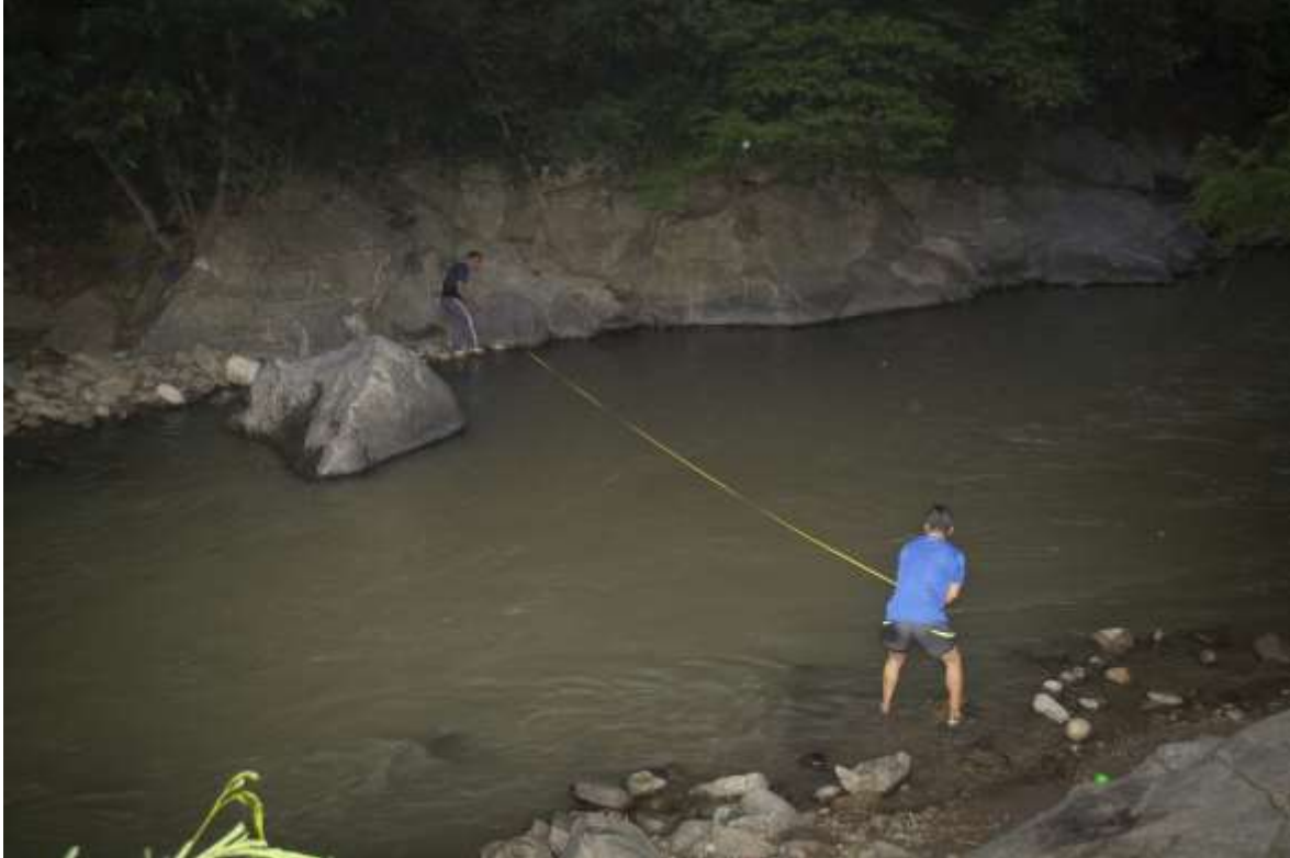
Figura 5. Medición del ancho del afluente
