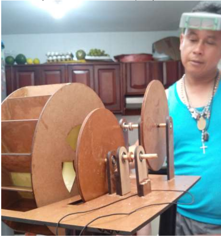
Figura 24. Molino ensamblado, acoplado y barnizado.
