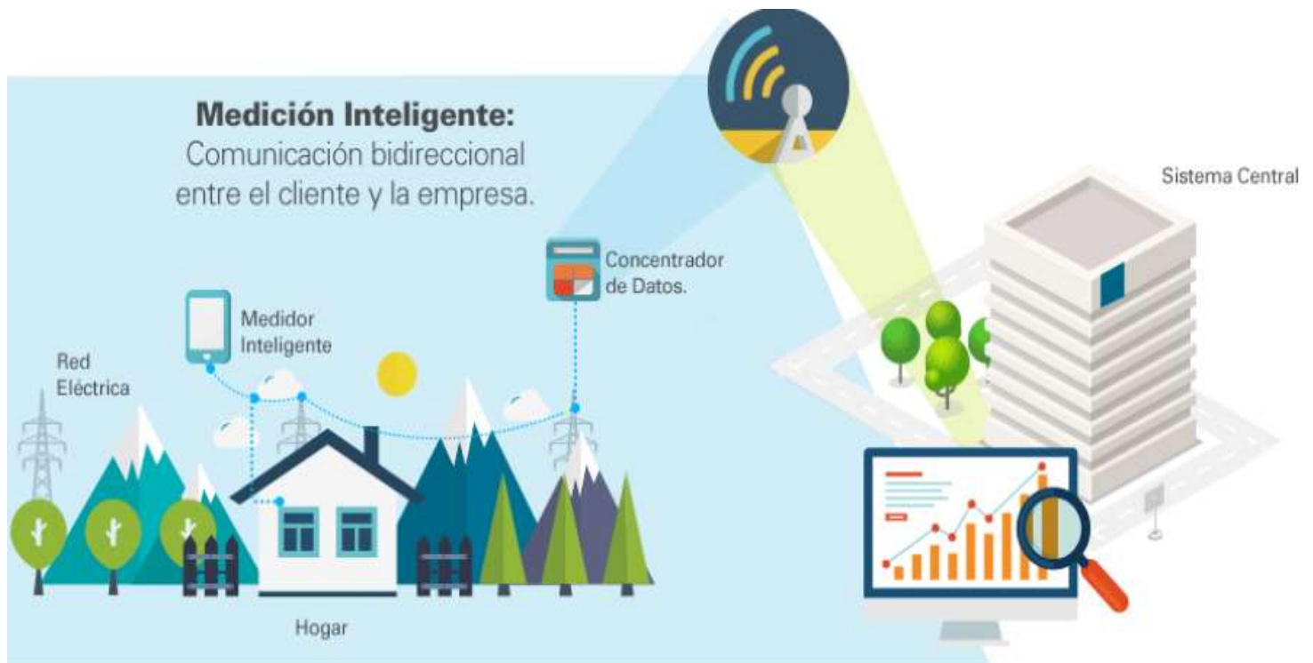
Figura 13. Infraestructura del sistema Smart Metering
