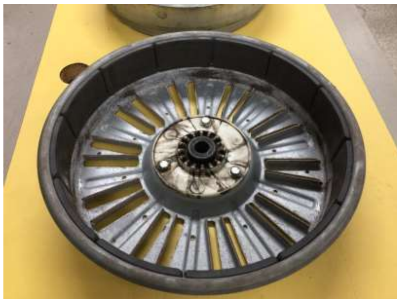
Figura 15: Disco con imanes de ferrita
