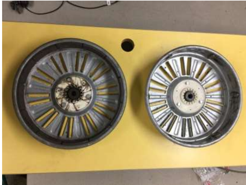
Figura 14: diferencia entre disco con imanes de neodimio y ferrita
