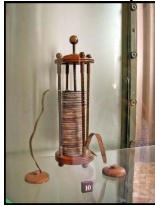
Figura 8. Pila voltaica de discos de cobre y de zinc y capas húmedas
