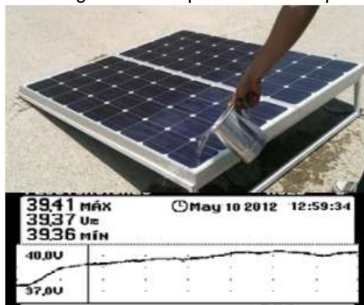
Figura 3. Condiciones de agua a 60 °C por encima del panel solar fotovoltaico.
