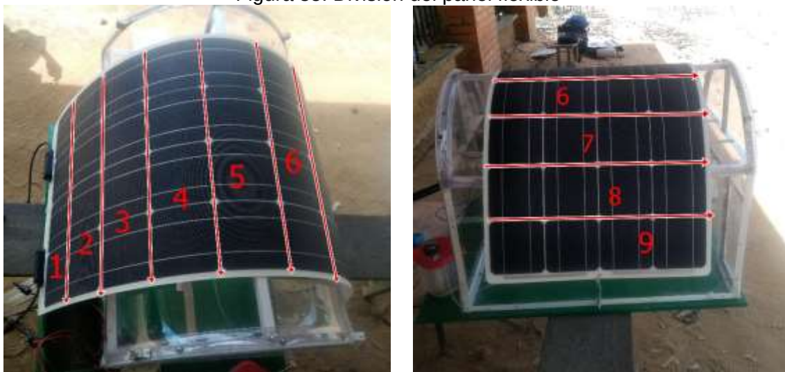
Figura 35. División del panel flexible
