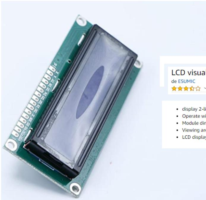
LCD visualización Módulo Para Arduino, Azul
