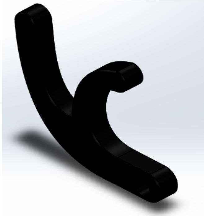
Vista del diseño final del pasador el cual asegura que la parte inferior y superior no se abran si así se requiere.
