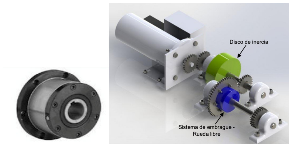
Figura 46. Rueda libre RENOLD F2-D2 25mm y ubicación en el sistema mecatrónico.
