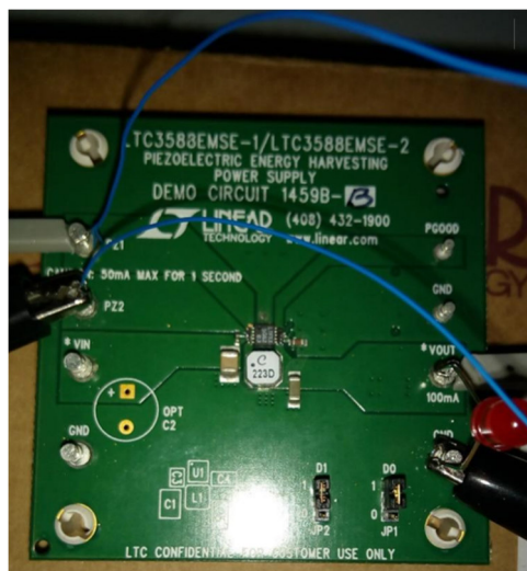
Figura 39. Conexión del LED y Mide Volture V22B con el Demo Circuit 1459B-A
