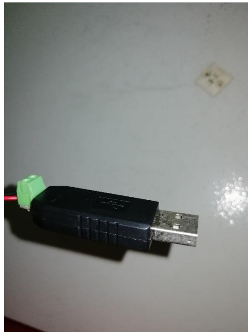
Figura 23. Modulo convertidor de USB a RS-485
