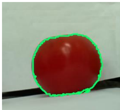
Figura 4. Contorno con OpenCV sobre una máscara de color rojo
