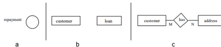
Figura 18. Representación de elementos de una BD con elementos del modelo ER: a) hecho, b) niveles-entidades y c) Relaciones entre entidades [20]
