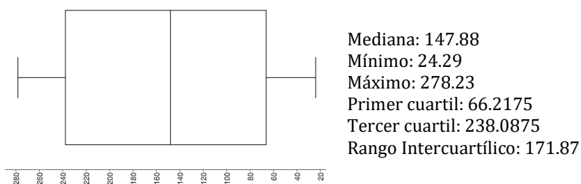
Figura 8. Distribución de valores de distancias máximas de cobertura para transmisores con potencia de 2390 Watts
