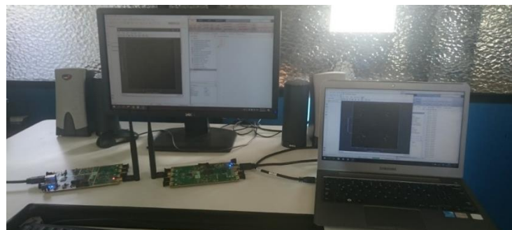
Figura 35. Sistema de transmisión empleando antenas omnidireccionales
