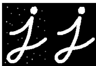
Figura 5. Transformación morfológica Opening sobre una imagen binarizada ( https://docs.opencv.org/3.0-beta/doc/py_tutorials/py_tutorials.html )
