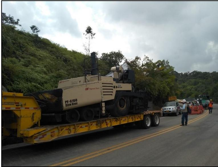
**Imagen 21.** Maquinaria de la obra: Pavimentadora Finisher
