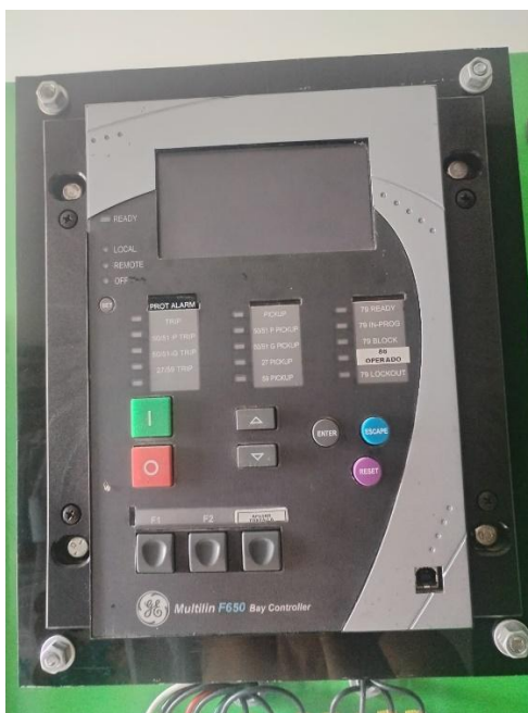
Figura 11. Integración del relé digital GE Multilin F650 Bay Controller en el banco de simulación.
