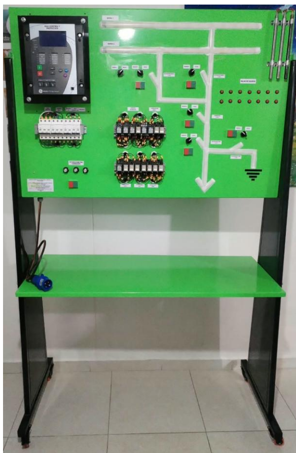
Figura 22. Banco de simulación de subestaciones eléctricas completamente integrado.
