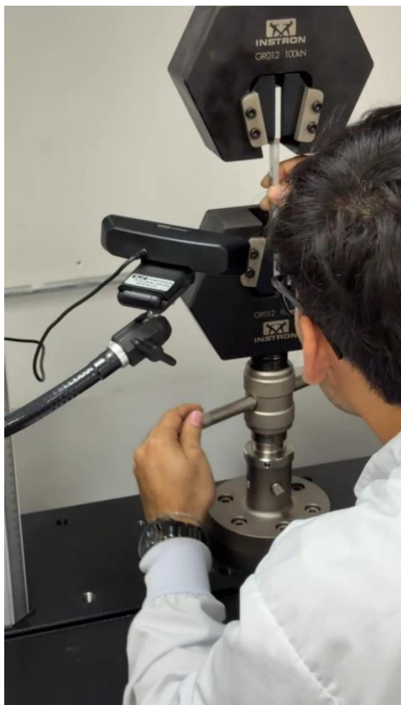
Figura 5. Montaje de probetas
