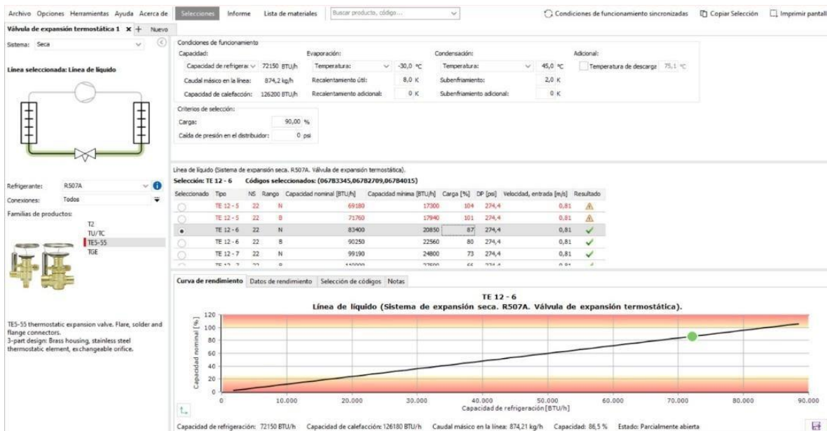
Figura 25. Selección de válvula de expansión termostática.
